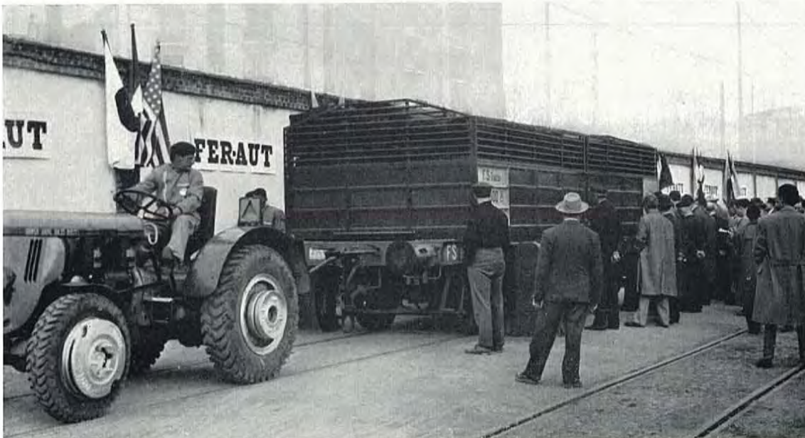
Lo stesso telaio ferroviario che era carico del serbatoio è stato spinto a ricevere il contenitore a sponde alte lasciato dal rimorchio e viene immesso al binario di partenza.
