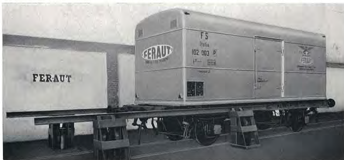
Fig. 11 - Telaio ferroviario che, ricevuto il contenitore isotermico, va alla rotaia.
