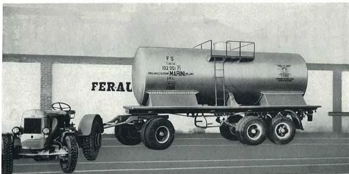
Fig. 10 - Rimorchio che, ricevuto il contenitore serbatoio lasciato dal telaio ferroviario, va alla strada.
