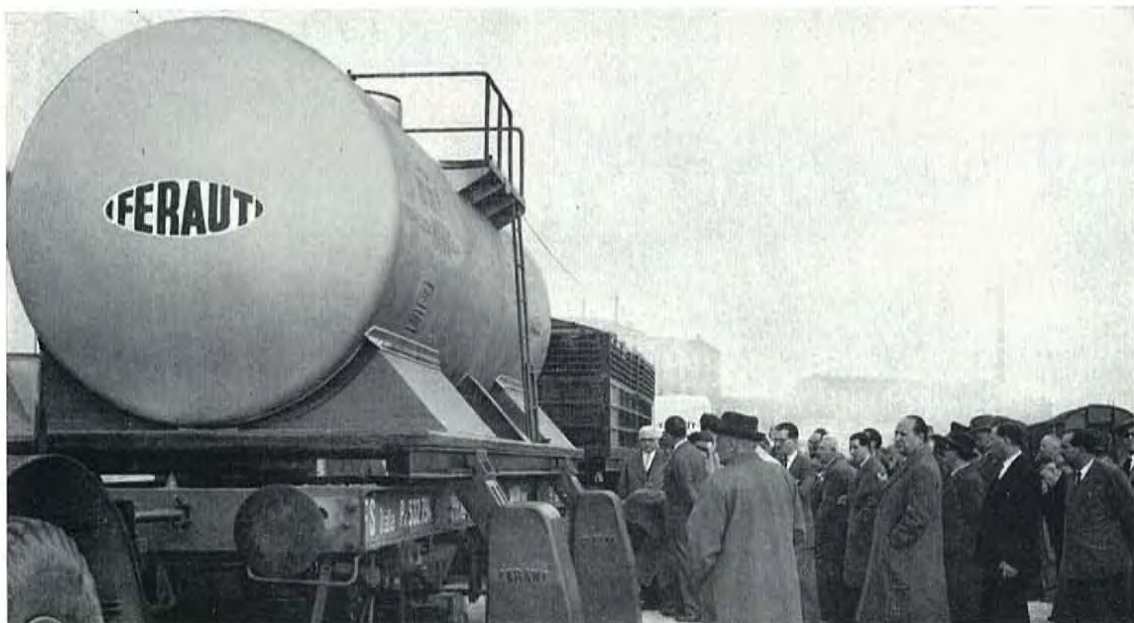
Gli esperti osservano l'effettuato sollevamento dei contenitori dal telaio ferroviario e dal rimorchio stradale.
