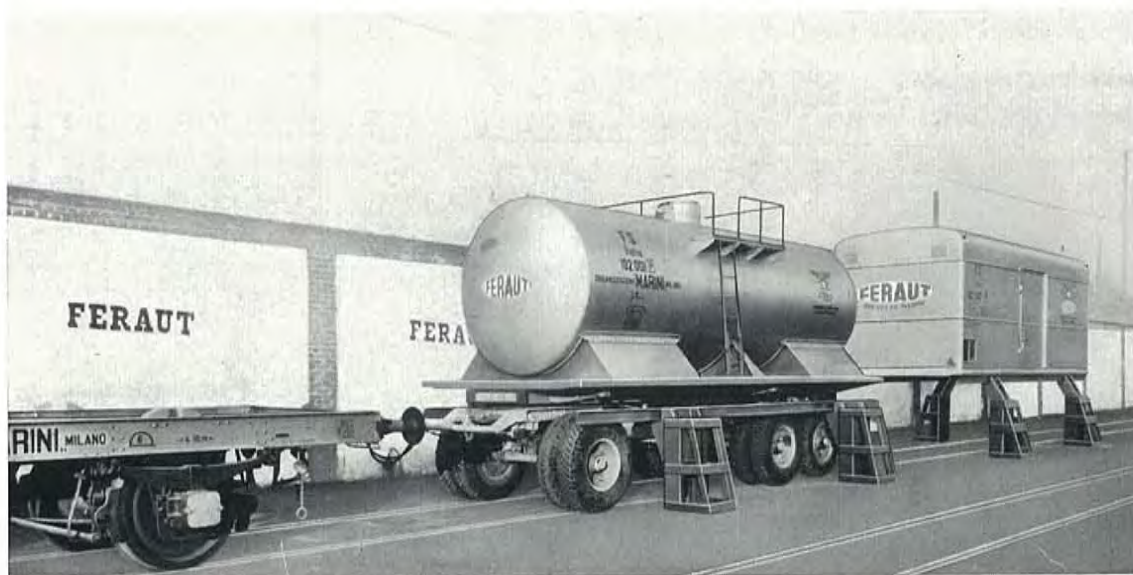
Fig. 9 - Dopo che l'impianto ha sollevato i 2 Contenitori dai loro veicoli, il telaio ferroviario, pilota il rimorchio a ricevere il contenitore serbatoio.
